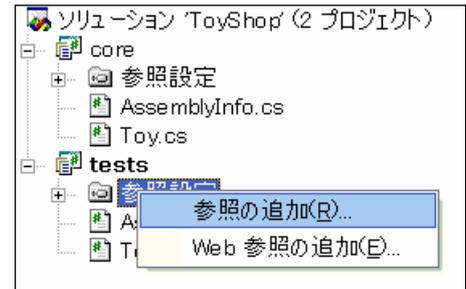
「参照の追加」ダイアログボックスの「プロジェクト」タブを選択して、選択ボタンを押します。選択されたコンポーネントのリストに追加されます。
